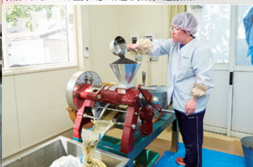
搾油機に菜種を投入。油カスは機械の下部に排出される
