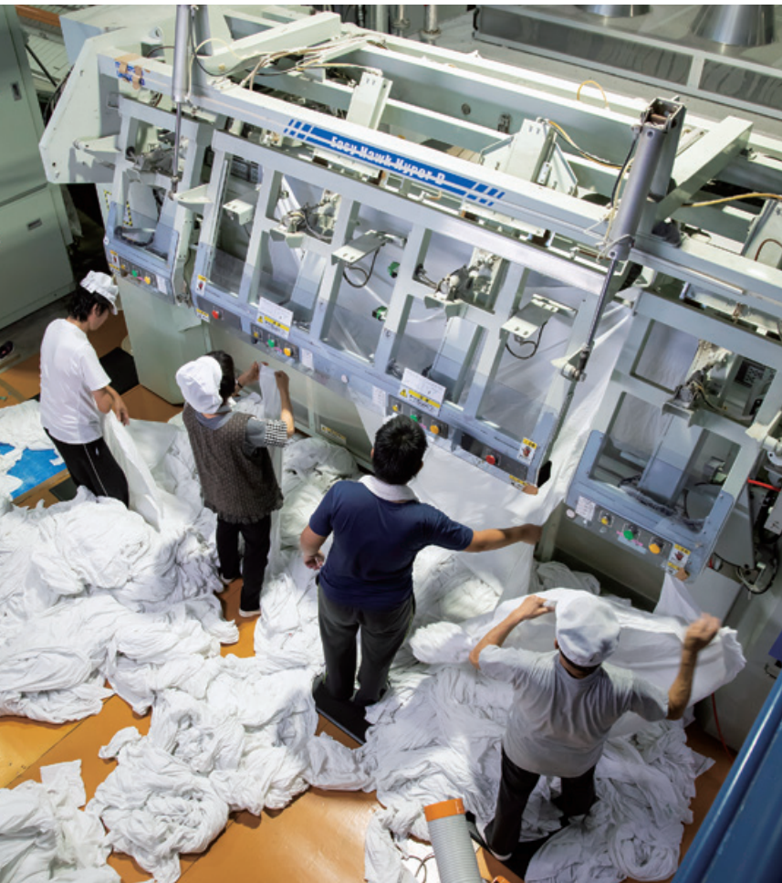
半乾きのシーツをクリップに止め、広がった順にローラーに。乾燥・アイロン・たたみまで自動化されている
