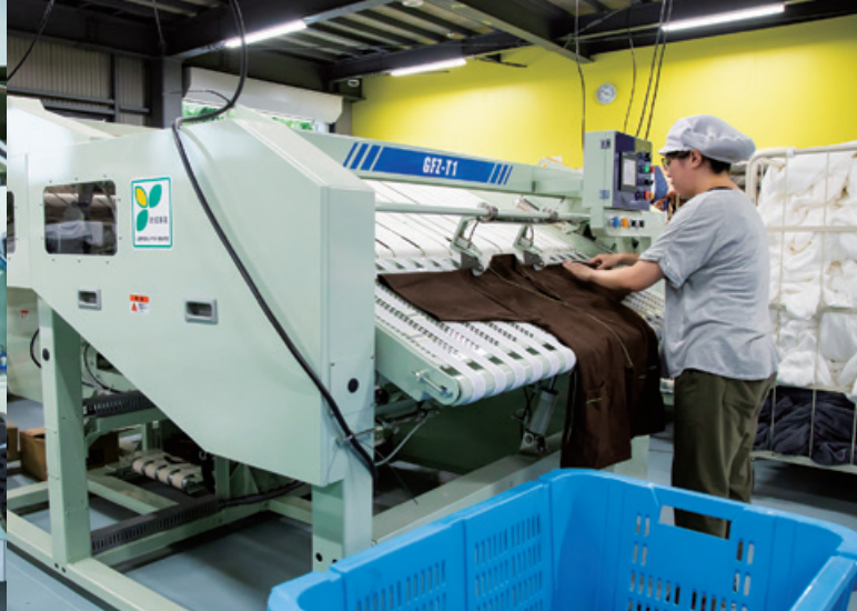
助成によって新たに整備された「ガウンフォルダー」(写真右)。広げた作務衣をセットすると自動的にたたまれてくる(写真左)。人海戦術で対応していた、たまたみ作業が一人でこなせるようになる
