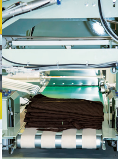
助成によって新たに整備された「ガウンフォルダー」(写真右)。広げた作務衣をセットすると自動的にたたまれてくる(写真左)。人海戦術で対応していた、たまたみ作業が一人でこなせるようになる
